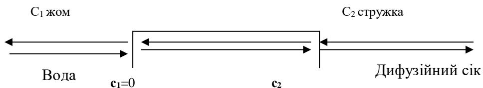
Рисунок 9.1 – Схема протитечійного вилучення сахарози з бурякової стружки
