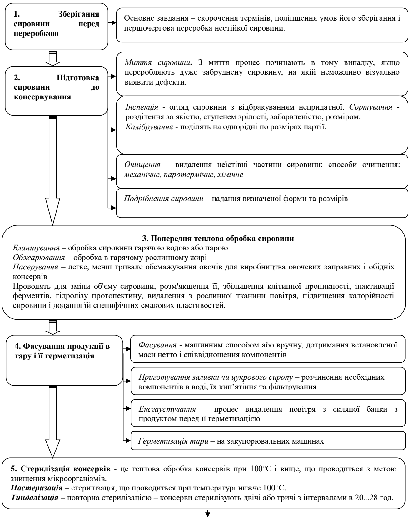
Рисунок 2.3 – Консервування тепловою обробкою
