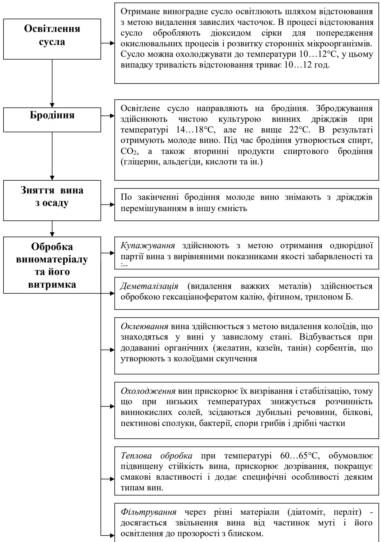
Рисунок 8.6 – Принципова схема отримання вина
