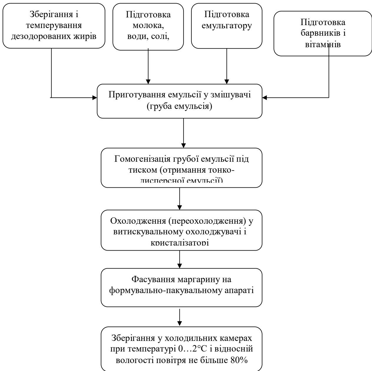
Рисунок 1.6 – Технологічна схема виробництва маргарину методом переохолодження
