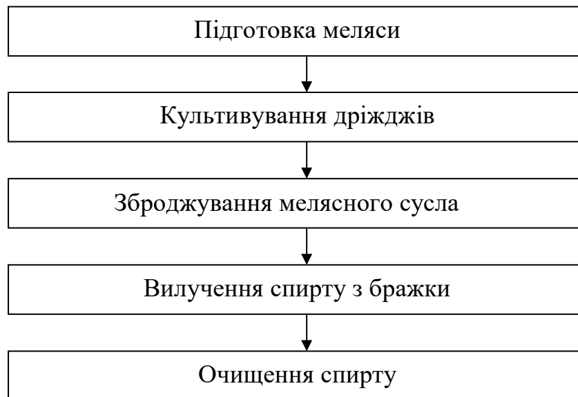
Рисунок 7.4 – Принципова технологічна схема виробництва спирту з меляси
