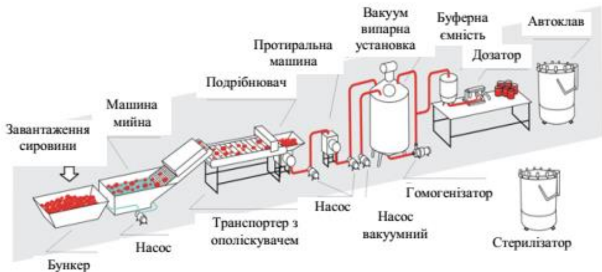
Рисунок 2.6 – Апаратурно-технологічна схема виробництва концентрованих томат-продуктів
