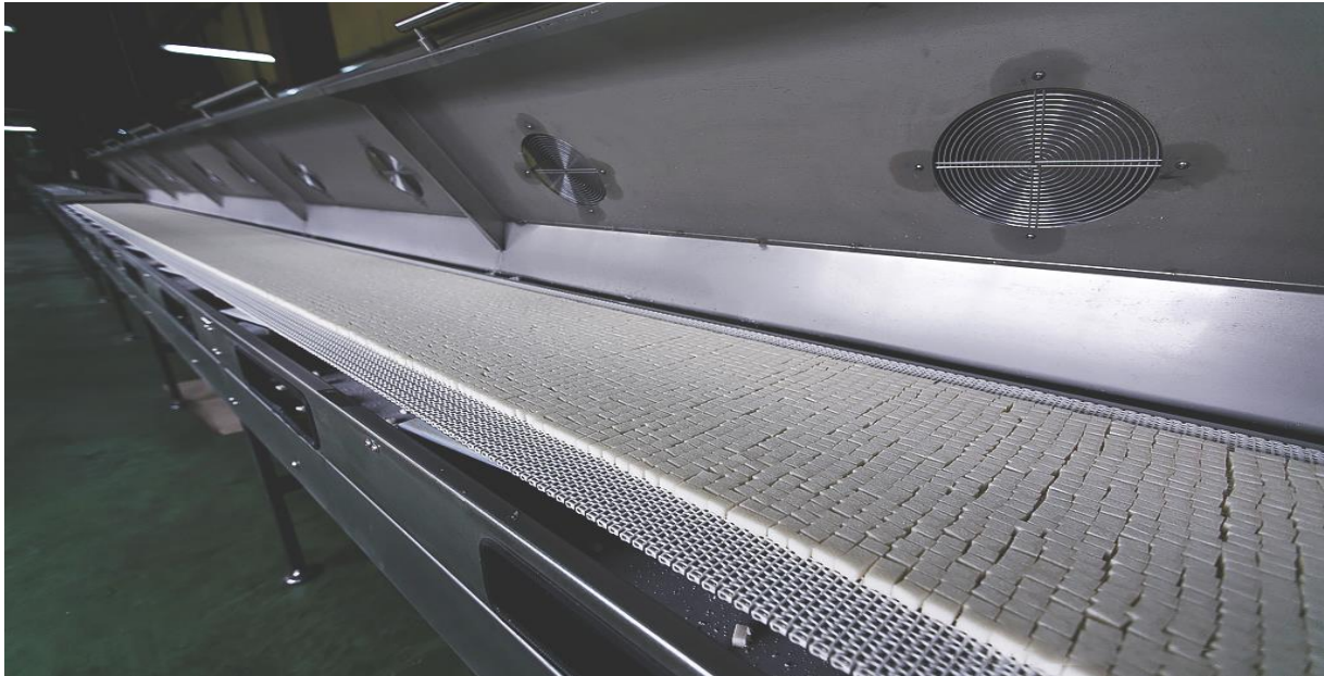
Рисунок 9.6 – Процес сушіння і охолодження цукру-рафінаду
