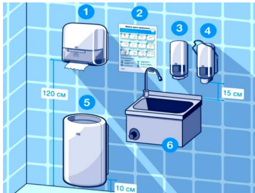
Рисунок 8 – Рекомендована схема облаштування рукомийника
